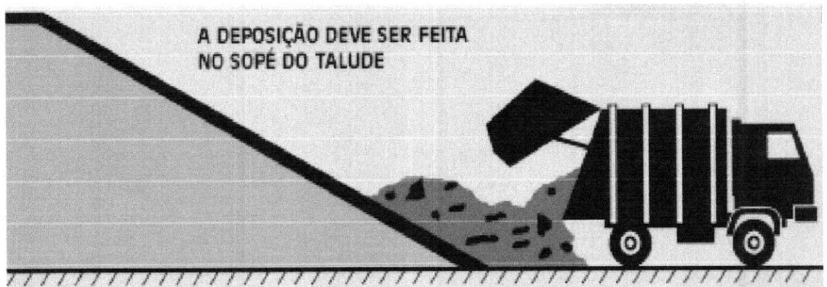
Figura 36. A descarga deve ser feita no sopé do talude
